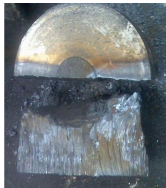
Рис. 4.8. Усадочные раковины в 8-ми заготовочных слитках колесной стали
