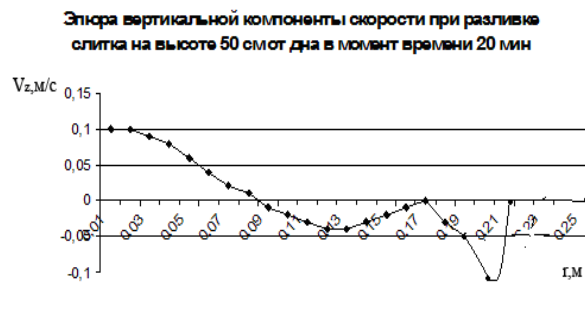
Рис.4.15. Эпюры вертикальной компоненты скорости по радиусу изложницы при разливке слитка в различные моменты времени
