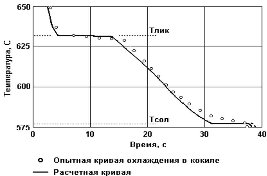
Рис.1.2. Кривые охлаждения для центра слитка \varnothing 55мм из сплава Al-5%Si, заливаемого в кокиль
