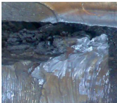
Рис. 4.8. Усадочные раковины в 8-ми заготовочных слитках колесной стали
