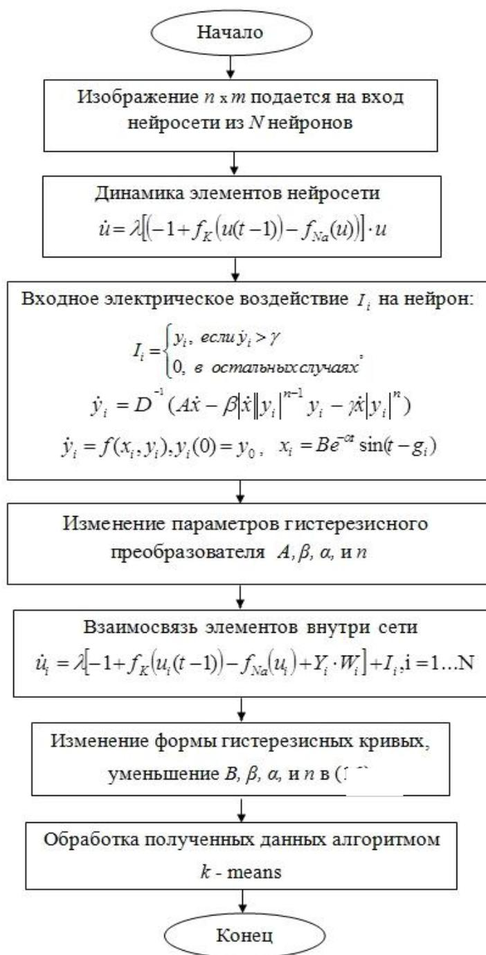
Рис. Алгоритм сегментации изображений с помощью биоИНС с ГФА
