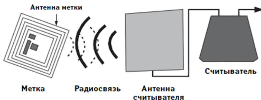
Рис. 1. Упрощенная схема системы СКУД на основе RFID
