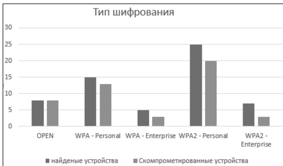
Рисунок 6 – Тип шифрования скомпрометированных устройств
