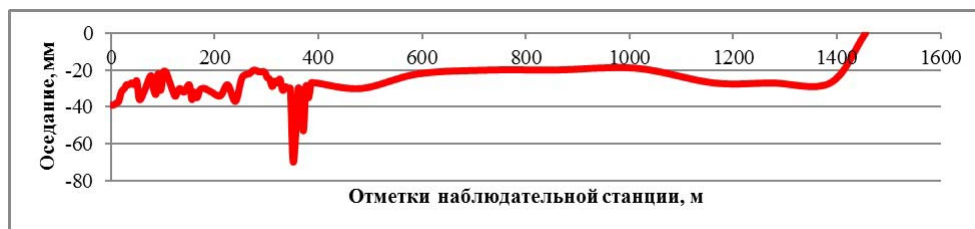
Рис. 1. – Визуализация результатов измерений на наблюдательной станции по ул. Первомайская, г. Горловка ш. "Кочегарка".
