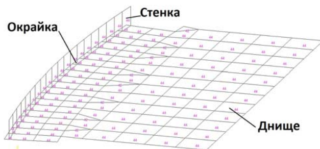
Рис. 4. Фрагмент днища КЭ модели ВЦР.
