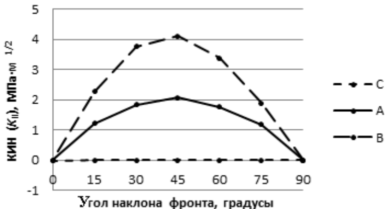
Рис. 7. Изменение значения K_{II} в выбранных точках фронта трещины по 6-му контуру
