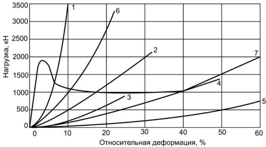
Рис. 1. Механические характеристики сборных опор различных конструкций:
