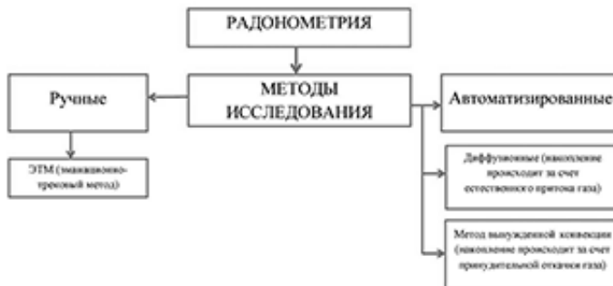
Рис. 6. Схематическое представление о методах измерения радона.
