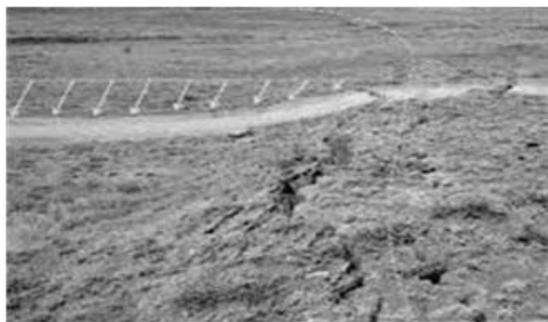
Рис. 1. Пример деформаций земной поверхности вызванной отработкой угольного пласта и подтоплением на участке шахты им. Румянцева.
