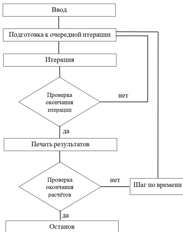
Рис. 2. Общая блок-схема программы моделирования процесса фильтрации.
