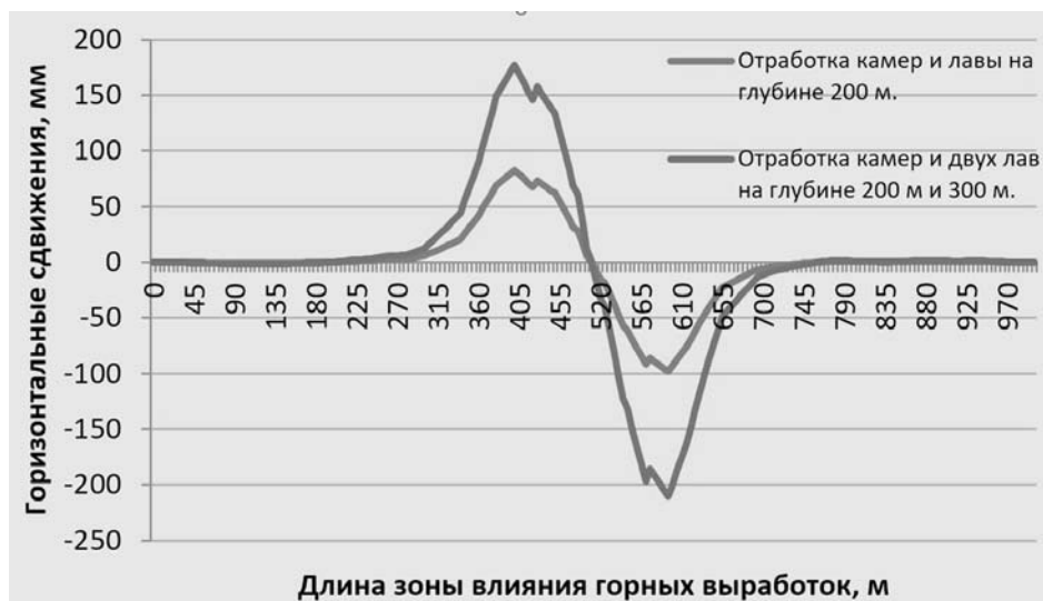
Рис. 7. Прирост горизонтальных сдвижений при повторной подработке горной выработкой межкамерных целиков
