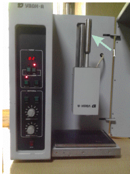
Рис. 1. Внешний вид ультразвукового диспергатора: 1 - концентратор
