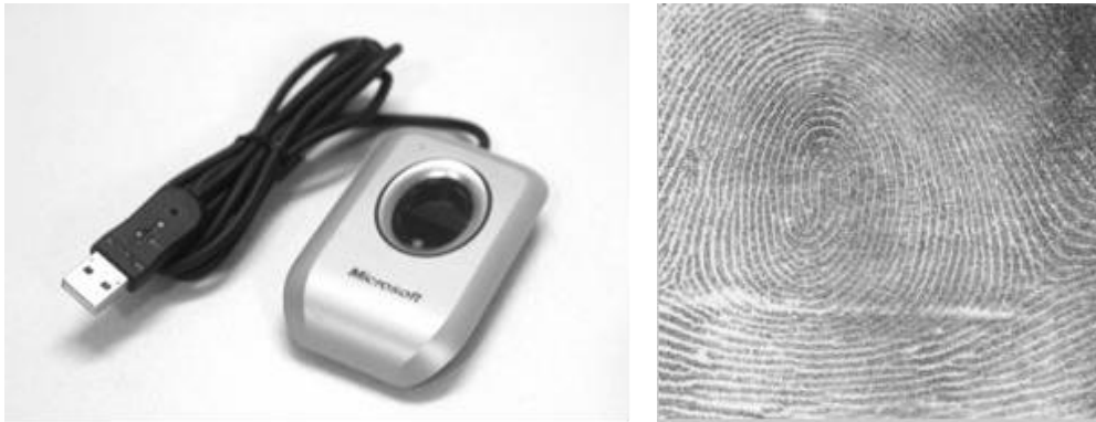
Рис. 1. Сканер отпечатков Microsoft 1033 и полученное с него полутоновое изображение
