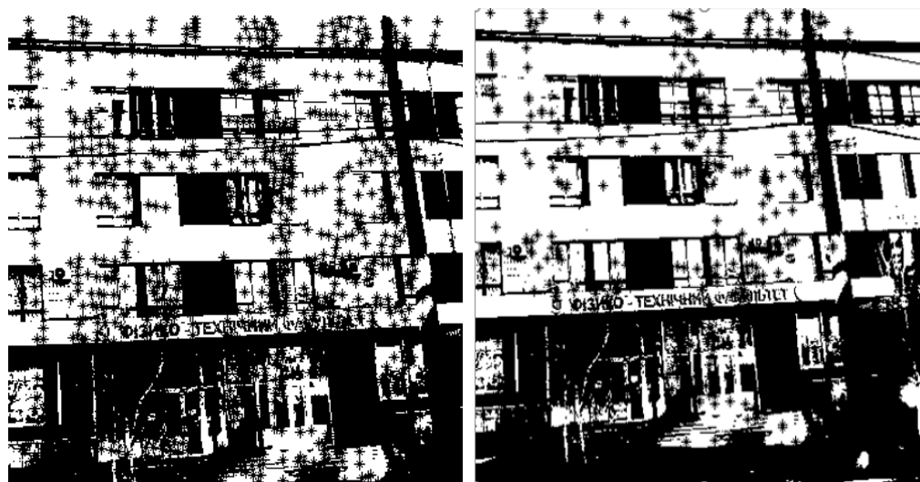
Рис. 2. Выделение углов на бинаризованном изображении, слева – метод Харриса, справа – метод FAST
