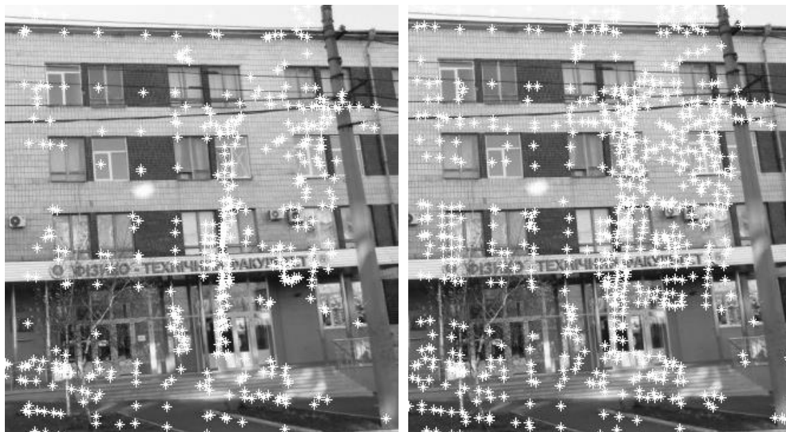
Рис. 1. Выделение углов, слева – метод Харриса, справа – метод FAST
