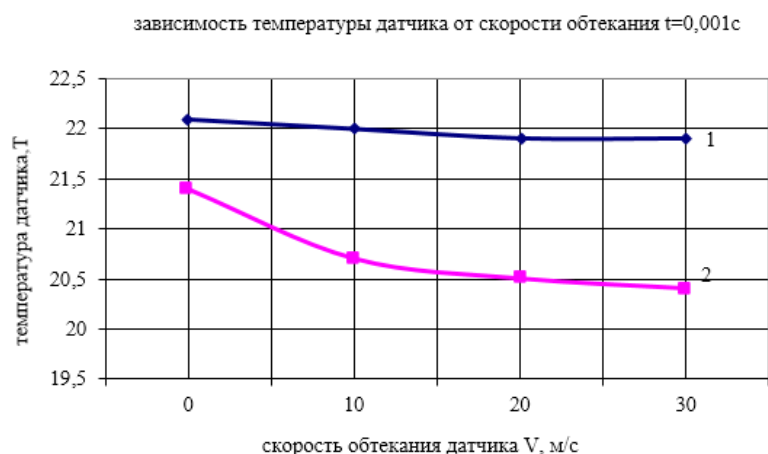
Рис. 2. Изменение температуры системы в зависимости от скорости обтекания внешней стенки в момент времени t = 0,001c ; (кривая 1 для 10 горизонтов в центре системы; кривая 2 для 10 горизонтов на внешней стенке системы)
