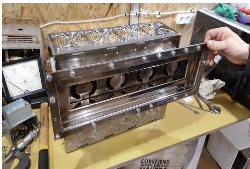
Рис. 7. Синхронизатор на четырех магнетронах
