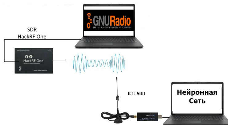
Рис. 11. Программно-аппаратная архитектура средства эмуляции и средства классификации сигнала
