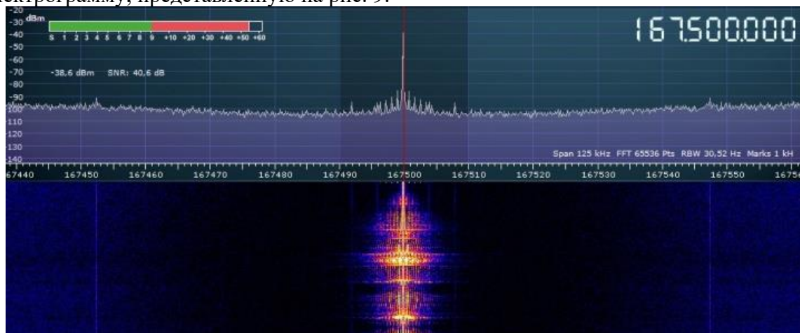
Рис. 9. Спектрограмма сигнала, передаваемого с HackRF One
