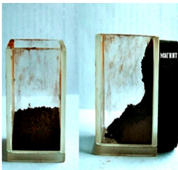
Рис. 4. Поведение полученного нанопорошка магнитного материала \text{NiFe}_2\text{O}_4 в магнитном поле
