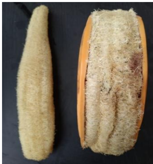
Рис. 4. Исходное сырьё и вид фильтрующего материала после эксплуатации
