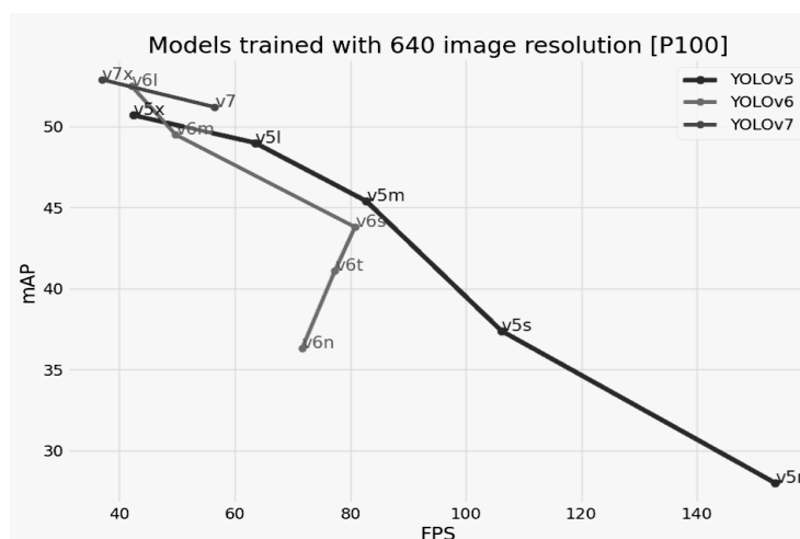
Рис. 3. Соотношение mAp и FPS для YOLOv5*,v6*,v7* с разрешением 640
