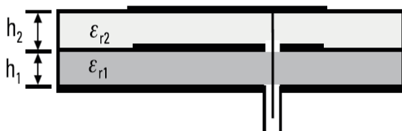
Рис. 9. Структура двухслойной двухдиапазонной антенны
