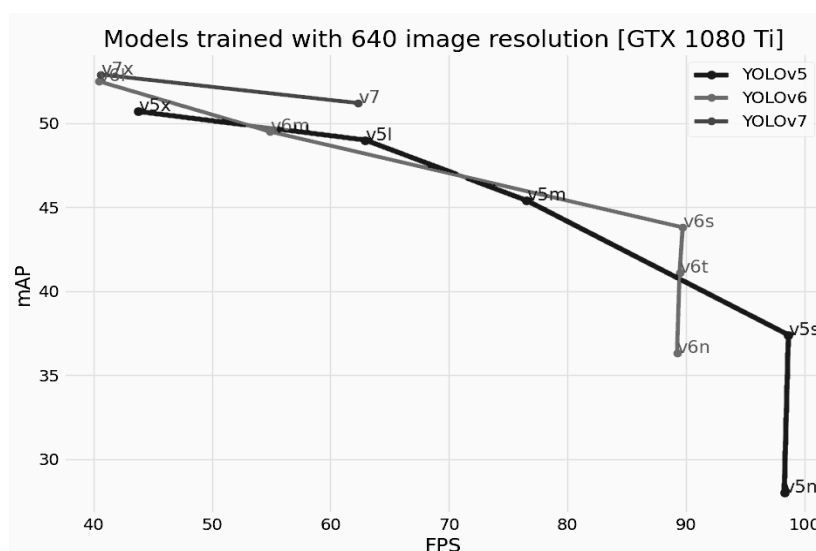
Рис. 4. Соотношение mAp и FPS для YOLOv5*,v6*,v7* с разрешением 640
