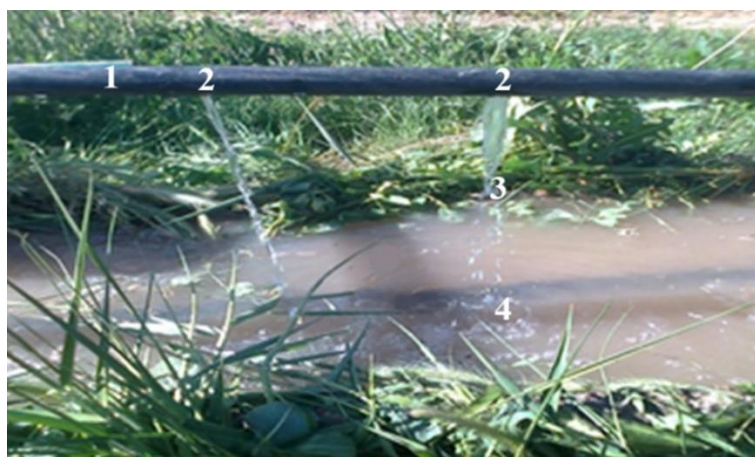
Рис.1. Общий вид экспериментальной установки: 1-труба для подачи паток недоочищенных стоков; 2-отверстия; 3-струи стоков; 4-приемная яма для стока
