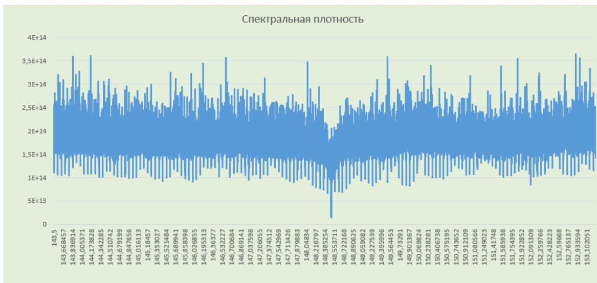
Рис. 3. Рассчитанная спектральная плотность сигнала ПЭМИН
