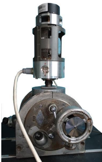
Рис. 4. Макет НПО на двухкоординатной оптической делительной головке ОДГ-10
