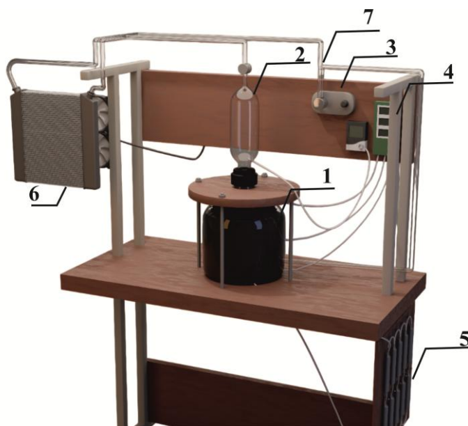
Рис. 1. Модель установки: 1- бак с трансформатором и трансформаторным маслом, 2 – расширительный бак, 3 – регулируемый компрессор, 4 – термометры электронные, 5 – сопротивления, 6 – радиатор с куллерами, 7 – трубки для циркуляции газа
