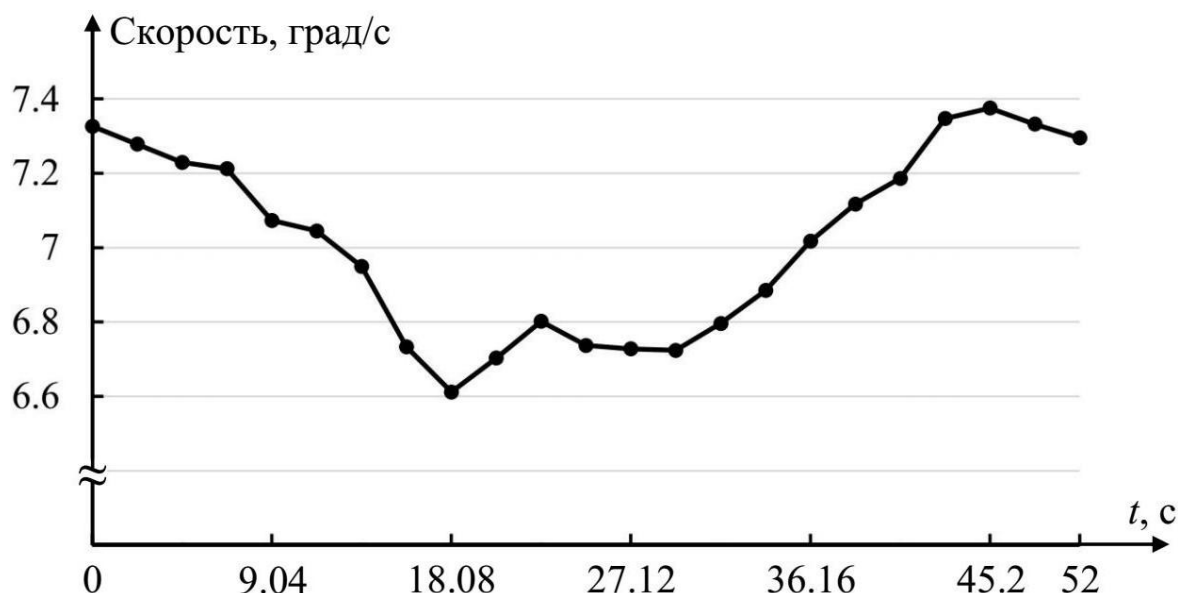
Рис. 6. График, отражающий изменение скорости вращения платформы в течение одного оборота
