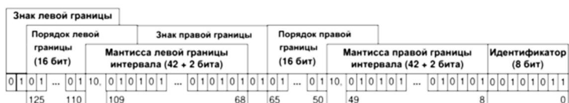
Рис. 2. Структура постбинарного формата Pб128/32ip [10]
