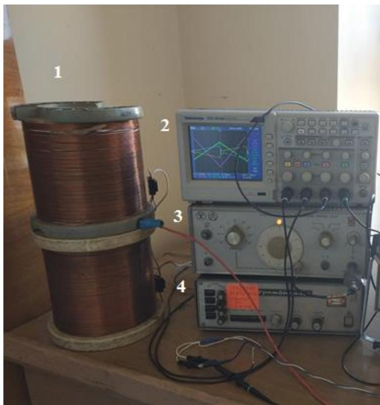
Рис. 1. Внешний вид устройства по обработке семян кукурузы сахарной переменным магнитным полем
