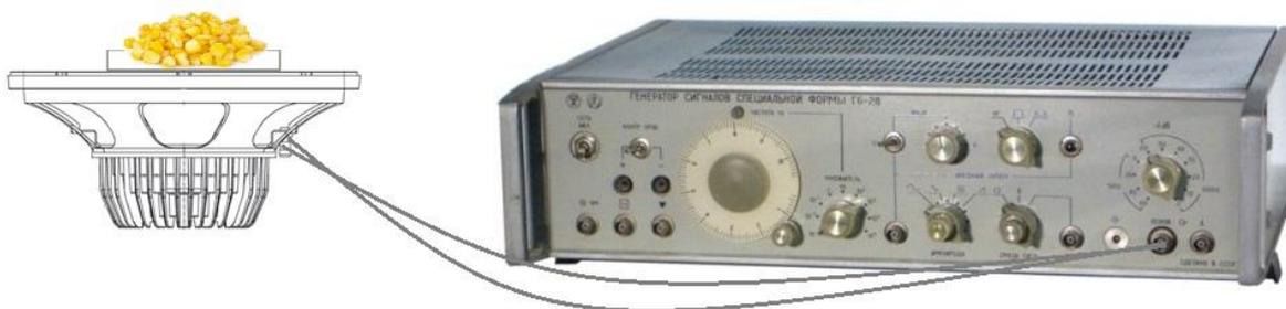
Рис. 2. Внешний вид вибрационной установки для обработки семян кукурузы сахарной
