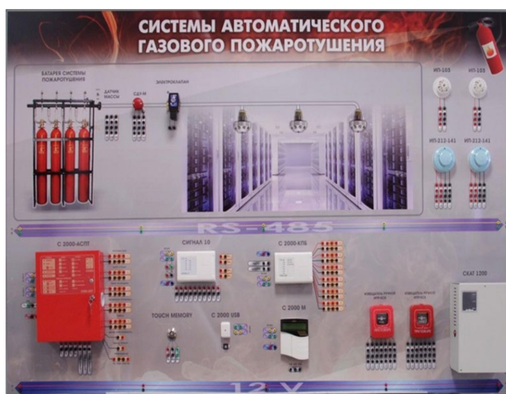
Рисунок 4 – Интерактивный лабораторный стенд
