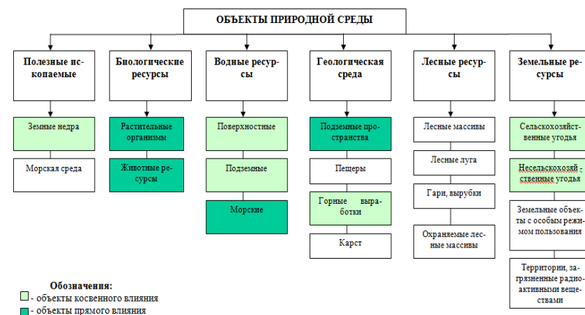
Рис. 3.25. Структурная схема взаимодействия угольного производства с объектами природной среды
