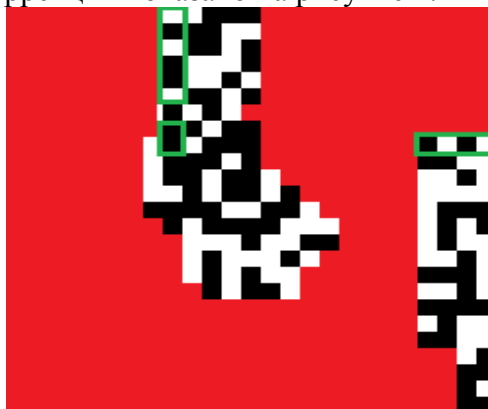
Рисунок 2 – Расположение битов кода маски и уровня коррекции
