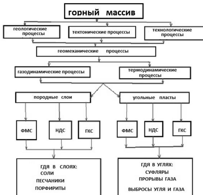
Рис. 1. Геомехано-газотермодинамическая модель формирования выбросоопасных зон на локальном и текущем уровнях: ФМС – физико-механические свойства породных слоев и угольных пластов; НДС – напряженно-деформированное состояние породных слоев и угольных пластов; ГКС – газокинетические свойства породных слоев и угольных пластов; ГДЯ – газодинамические явления
