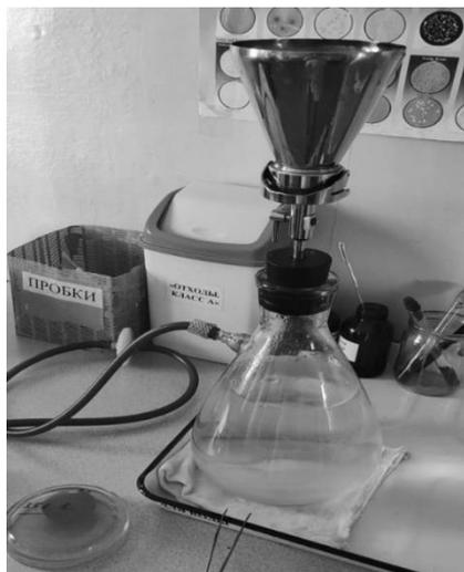
Рис. 1. Установка для фильтрации воды
